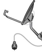
2. Conectá el cable coaxial en la entrada SAT IN del decodificador.
